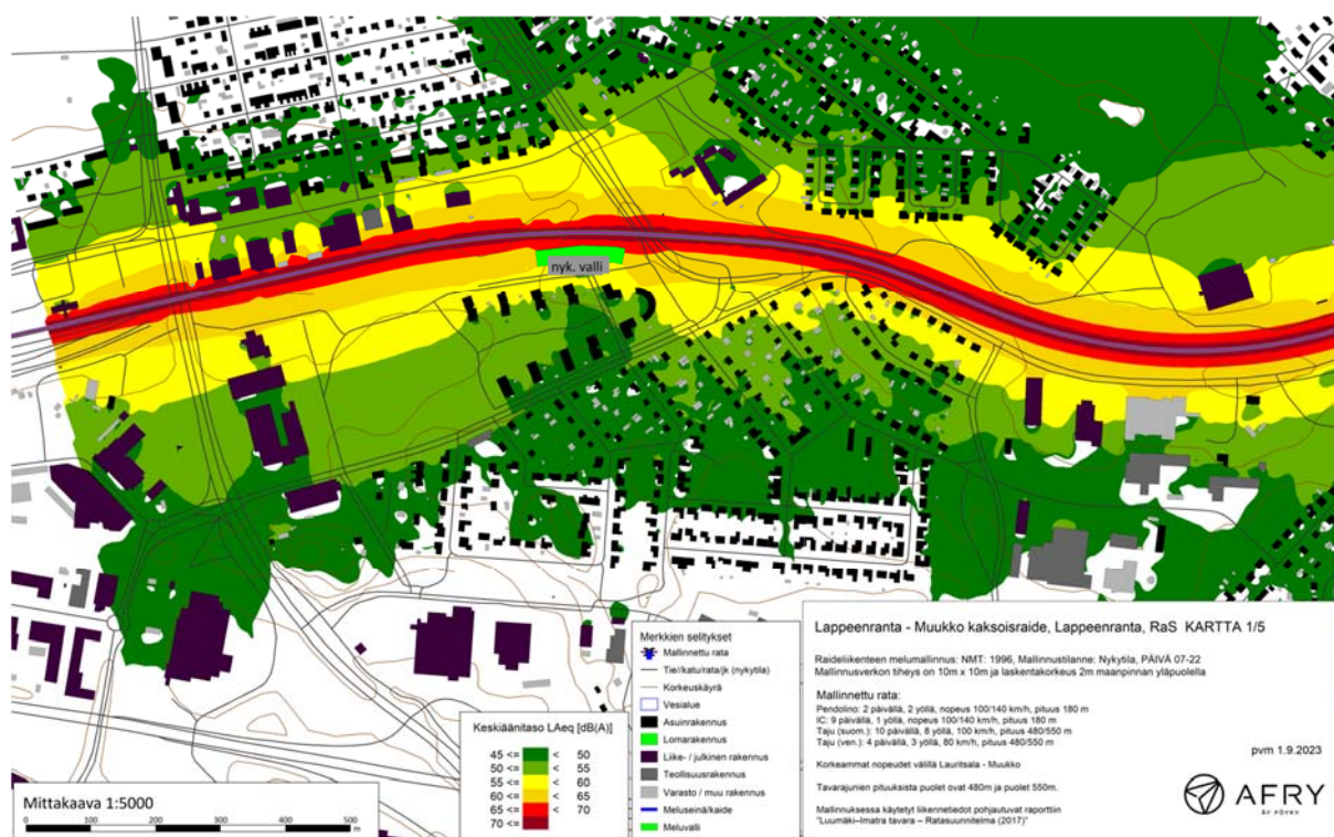
Kuva 18. Vanha Viipurintie - Hietalankatu, päiväajan keskiäänitasot nykytilanteessa. (Afrý, 2023a).
